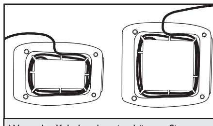
Wenn das Kabel zu lang ist, können Sie den überschüssigen Teil mithilfe der Kabelaufwicklung unten am Gerät verstauen. Die Füße des Toasters sind so hoch, dass Sie das Kabel an jeder Seite herausführen können.
