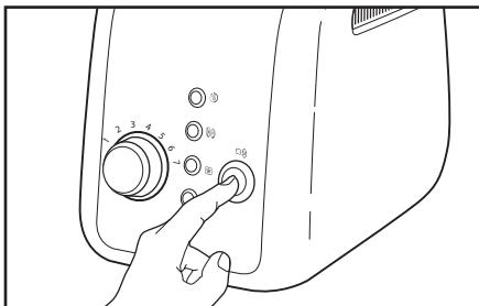
**5** Чтобы начать поджаривание, нажмите кнопку Поджаривание/Отмена ( ). Самоустанавливающиеся решетки автоматически открываются для удерживания хлеба в вертикальном положении. По окончании процесса поджаривания раздастся звуковой сигнал окончания цикла, тостер отключится и поднимет тосты.
