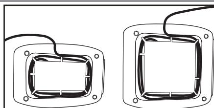
В случае необходимости сократите длину шнура, намотав его с помощью приспособления, находящегося под основанием тостера. Ножки тостера достаточно высокие, поэтому шнур питания может выходить с любой стороны прибора.
