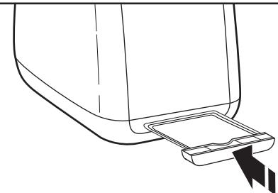
**4** Tackę na okruchy ponownie umieścić w tosterze, a następnie docisnąć do zatrzaśnięcia na miejscu. Nie używać tostera bez zamontowanej tacki na okruchy.
