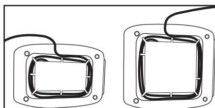
Si es necesario, enrolle el cable en la base para acortarlo. Los pies de la tostadora son lo suficientemente altos para que el cable salga por cualquier lateral.
