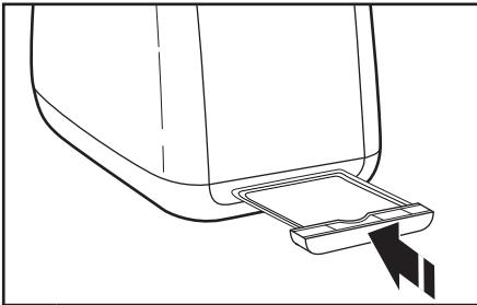
**4** Τοποθετήστε ξανά το δίσκο για ψίχουλα στη φρυγανιέρα. Πατήστε καλά έως ότου κουμπώσει στη θέση του. Μη χρησιμοποιείτε τη φρυγανιέρα χωρίς το δίσκο για ψίχουλα.
