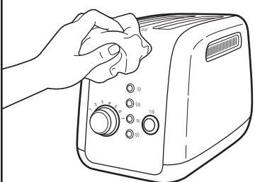
**3** Tørk av brødristeren med en myk, fuktig bomullsklut. Ikke bruk papirtørk, skurende rengjøringsmidler eller flytende rengjøringsmidler. Dypp aldri maskinen i vann.
