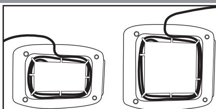
Si nécessaire, raccourcissez le cordon électrique en l'enroulant sous la base de l'appareil. Les pieds du grille-pain sont suffisamment hauts pour que le cordon puisse passer sous celui-ci de tous les côtés.
