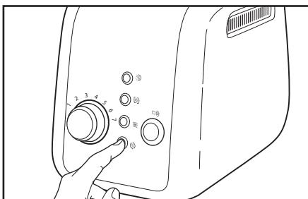
**4** (Alternativt) Tryck på och håll specialfunktionsknappen intryckt. Mer information finns under "Använda brödrostens specialfunktioner".
