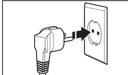
I Enchufe el cable de alimentación a una toma con conexión a tierra.
