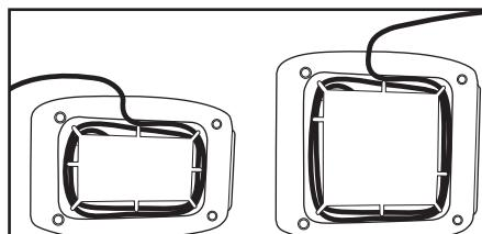
Accorciare il cavo, se necessario, avvolgendolo sotto la base. I piedini del tostapane sono alti a sufficienza da consentire al filo di fuoriuscire da qualsiasi lato dell'apparecchio.
