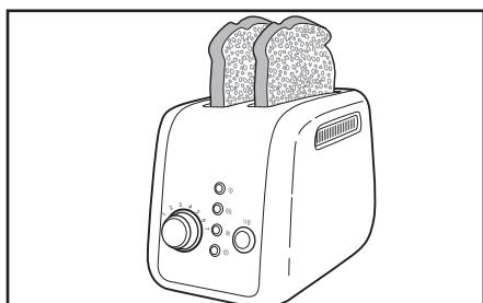
**1** Insérez les aliments dans la fente du grille-pain. N'insérez pas d'aliments beurrés ou garnis dans le grille-pain. Utilisez la fonction Réchauffer uniquement pour les aliments secs.
