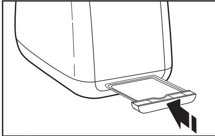
**4** Riposizionare il vassoio raccoglibriciole nel tostapane. Premere saldamente fino a che non scatta in posizione. Non utilizzare il tostapane senza avere prima posizionato correttamente il vassoio raccoglibriciole.
