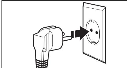
I Branchez le câble d'alimentation dans une prise avec raccordement à la terre.
