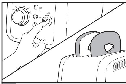
5 Du kan til enhver tid annullere ristningen ved at trykke på rist/annuller ( □△ ). Brødristeren slukker og løfter bagelen.
