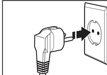
I Kytke virtajohto maadoitettuun pistorasiaan.
