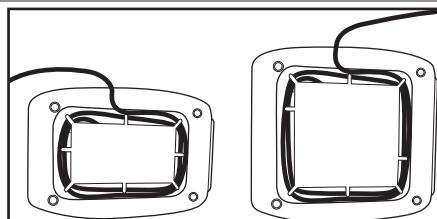
Se necessário, encurte o cabo de alimentação, enrolando-o por baixo da base. Os pés da torradeira têm uma altura suficiente para permitir que o cabo de alimentação saia por qualquer um dos lados do aparelho.
