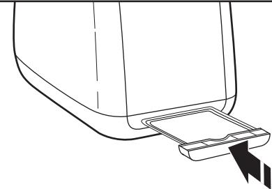
**4** Setzen Sie die Krümelschublade wieder ein. Drücken Sie dabei auf die Schublade, bis sie einrastet. Verwenden Sie den Toaster niemals ohne korrekt eingesetzte Krümelschublade.
