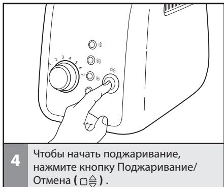
**4** Чтобы начать поджаривание, нажмите кнопку Поджаривание/Отмена (トースト/キャンセル).
