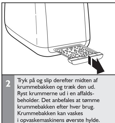
**2** Tryk på og slip derefter midten af krummebakken og træk den ud. Ryst krummerne ud i en affaldsbeholder. Det anbefales at tømme krummebakken efter hver brug. Krummebakken kan vaskes i opvaskemaskinenens øverste hylde.
