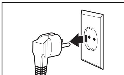
**1** Przed przystąpieniem do mycia tosteru należy upewnić się, że jest on odłączony od sieci zasilającej.
