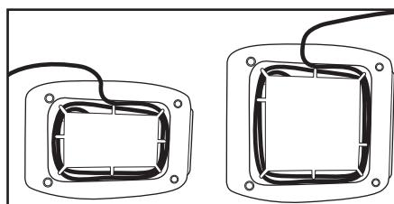
Jeśli jest to konieczne należy skrócić przewód zasilający nawijając go na zaczepy w spodzie podstawy. Nóżki toastera są na tyle wysokie, że umożliwiają wyjęcie przewodu z każdej strony urządzenia.
