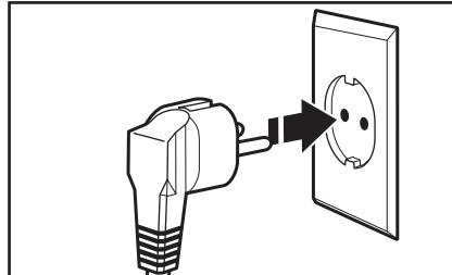
I Ligue o cabo eléctrico a uma tomada com ligação à terra.
