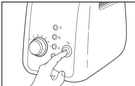
**5** Drücken Sie zum Starten des Röstvorgangs die Taste Toast/Ende ( ). Die automatische Zentrierung hält die Speisen automatisch aufrecht. Nach dem Röstvorgang ertönt das Abschlussignal, der Toaster wird abgeschaltet und die Scheiben werden angehoben.
