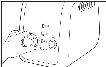
**3** Stellen Sie den gewünschten Bräunungsgrad mithilfe des Bräunungsreglers ein. Drehen Sie den Regler für dunkleren Toast nach rechts und für helleren Toast nach links.
