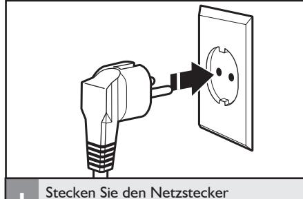
I Stecken Sie den Netzstecker in eine Schuko-Steckdose.
