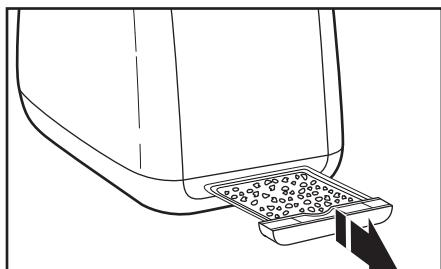
**2** Нажмите на центральную часть поддона для крошек, отпустите и выньте его. Выбросьте крошки в мусорное ведро. Мы рекомендуем очищать поддон для крошек после каждого использования тостера. Поддон для крошек можно мыть на верхнем уровне посудомоечной машины.
