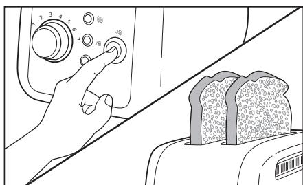
**4** Вы можете остановить процесс разогрева в любое время, снова нажав кнопку Поджаривание/Отмена ( □△ ). Тостер поднимет тосты и выключится.
