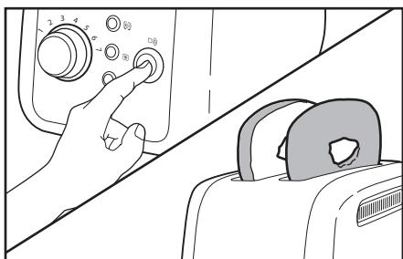
**5** Para cancelar el proceso de tostado en cualquier momento, pulse de nuevo Tostar/Cancelar ( ). La tostadora eleva el bollo y se apaga.
