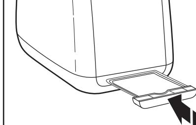
**4** Vuelva a introducir la bandeja recogemigas en la tostadora. Empújela hacia dentro firmemente hasta que encaje en su lugar. No utilice la tostadora sin la bandeja recogemigas.
