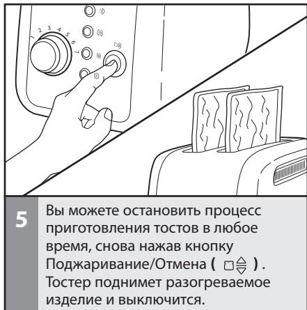
**5** Вы можете остановить процесс приготовления тостов в любое время, снова нажав кнопку Поджаривание/Отмена (トースト/キャンセル). Тостер поднимет разогреваемое изделие и выключится.
